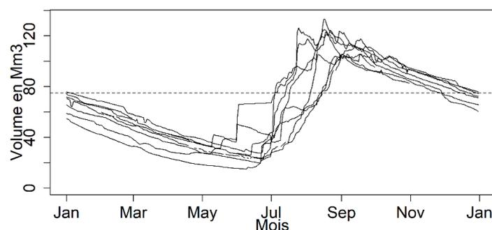
*Figure A. 23 : Evolution du volume d'eau dans le barrage de Dourou selon les mois de l'année*
