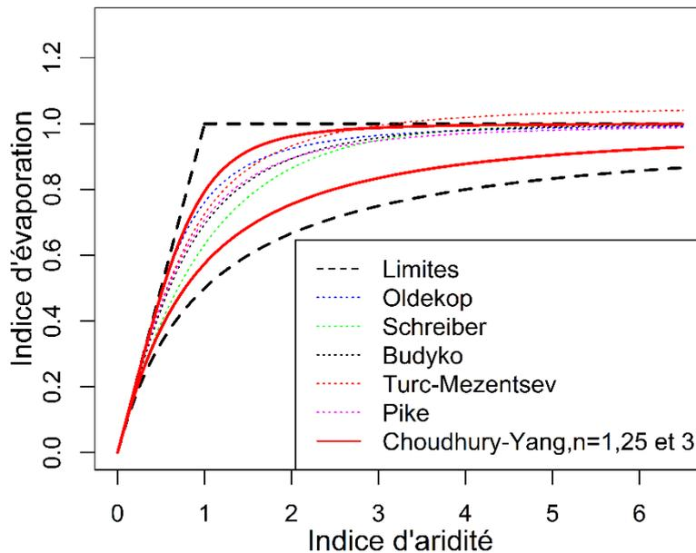
Figure C. 5: Modèles non paramétriques et celui paramétrique de Choudhury-Yang
