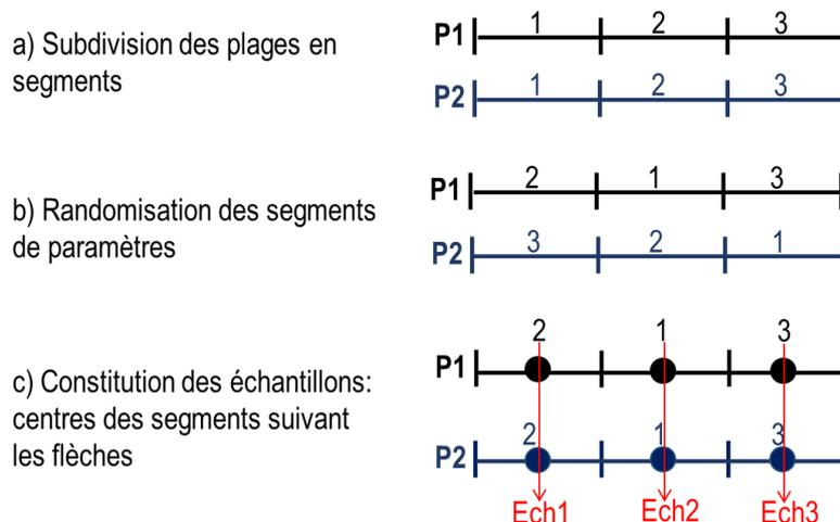
Figure D. 8 : Mise en œuvre de l'échantillonnage par Hypercube Latin
