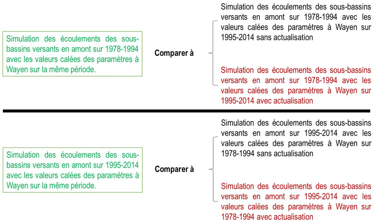
*Figure D. 19 : Transferts des paramètres calés à Wayen vers les sous-bassins en amont*
