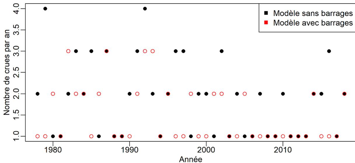
Figure D. 28 : Effet des barrages sur la fréquence des crues
