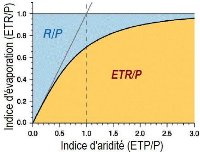
Figure C. 2: Partitionnement du cadre de Budyko (adaptée de Donohue et al. (2012))
