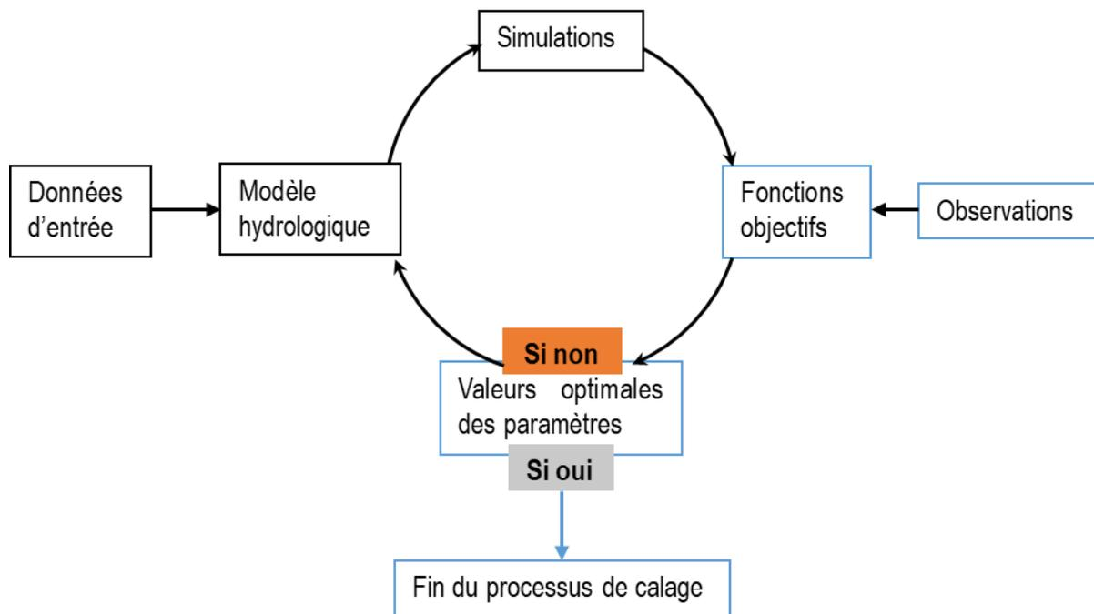
Figure A. 4: Procédure d'ajustement des paramètres d'un modèle hydrologique
