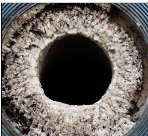
dépôt de struvite dans une canalisation
