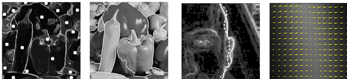
(a) Image de test utilisée pour le calcul de la ligne de partage des eaux continue. A gauche : l'image d'entrée avec des marqueurs, à droite le résultat.
