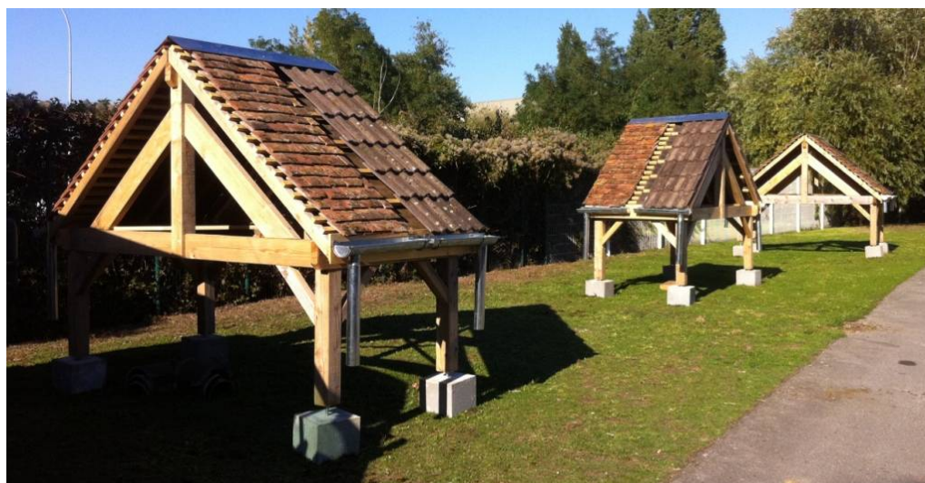
Figure 32: bancs d'essais pour le suivi du lessivage du benzalkonium
