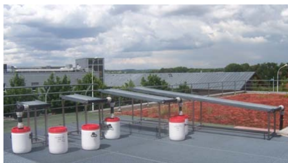
Figure 27. Dispositif "Flûte de pan" testant les différentes longueurs (à gauche) et Pyramides permettant d'appréhender l'effet de l'inclinaison (à droite)
