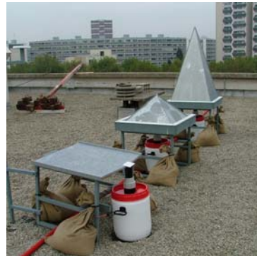
Figure 27. Dispositif "Flûte de pan" testant les différentes longueurs (à gauche) et Pyramides permettant d'appréhender l'effet de l'inclinaison (à droite)
