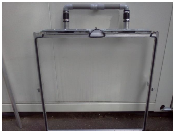
Figure 6 Délimitation de la zone carrée étudiée par des montants métalliques et jointés et présence des balais d'aspiration sur un côté
