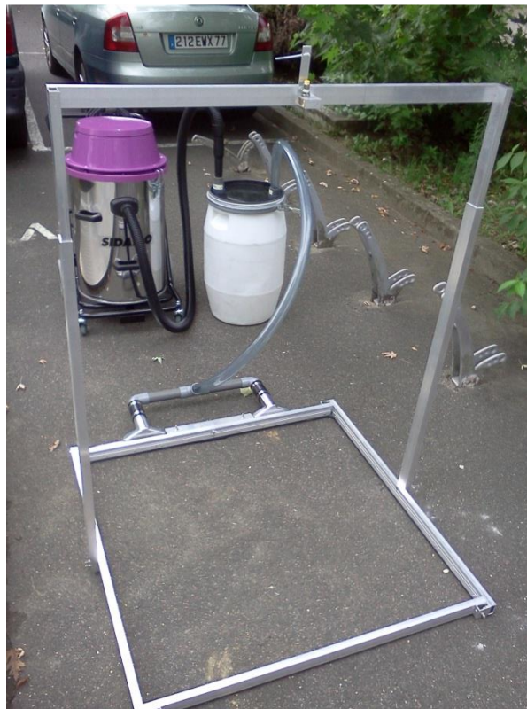
Figure 8 Photo d'ensemble du dispositif d'analyse du lessivage
