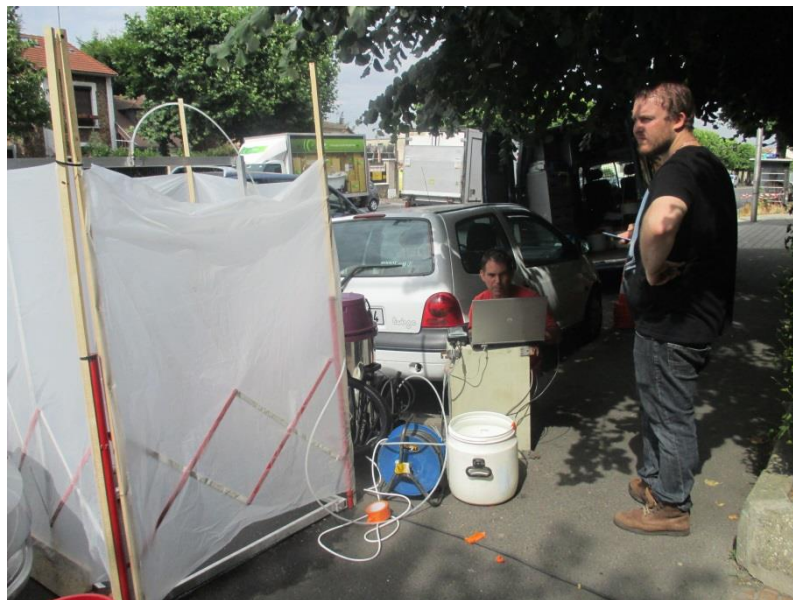
Figure 9 Dispositif expérimental d'analyse du lessivage protégé des vents latéraux par des bâches
