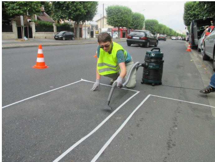
Figure 4 Réalisation du protocole d'aspiration à sec
