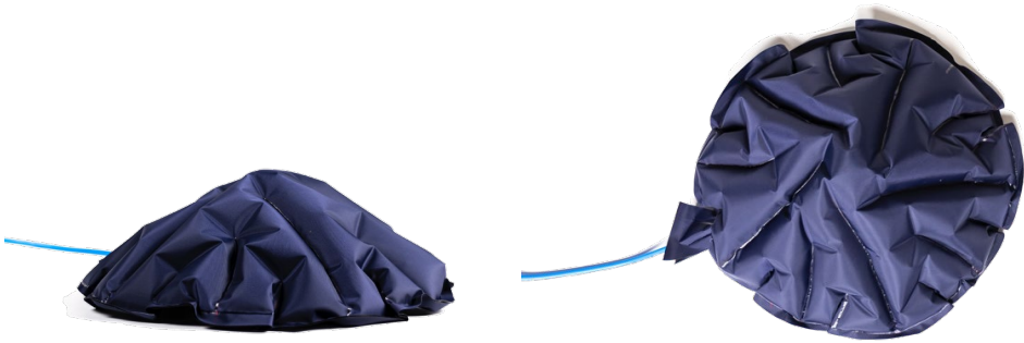
Fig. 4. Maquette fabriquée avec deux épaisseurs de toiles en nylon soudées selon un motif 2D.
