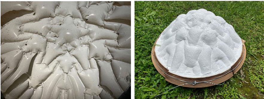
Fig. 15. Une coque en béton coulée à plat, puis mise en forme par le gonflage de la membrane.
