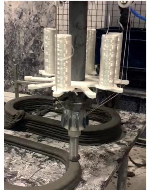
Figure 1. Impression de mortier fibré en continu © ENPC/Navier, 2020.
