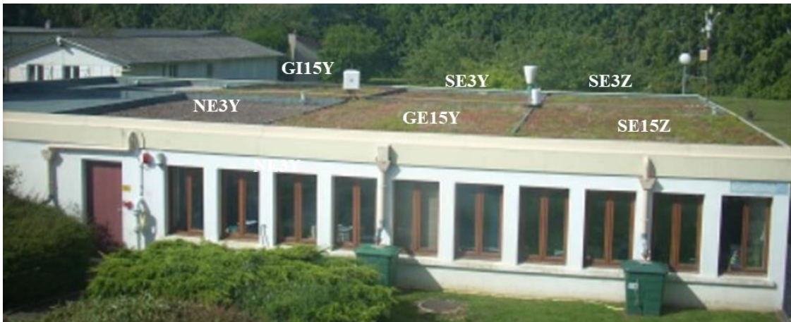
Figure 1: Toiture végétalisée de Trappes. À droite du toit se trouve la station météo, à gauche de cette station, le pluviomètre. Les bacs verts au pied du bâtiment contiennent les augets pour la mesure des débits de drainage issus des gouttières. Les symboles sont définis selon : G : Graminées, S : Sedum, E : Extensive, I : Intensive, 15 cm ou 3 cm pour l'épaisseur de substrat, polystyrène expansé (Y) ou pouzzolane (Z) pour la nature de la couche de drainage et N pour sol nu.
