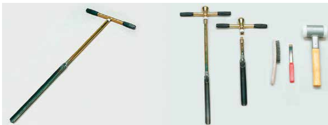
Figure 10.3 – Exemples de tarières permettant de réaliser l'échantillonnage de sol (longueur 30 à 50 cm, diamètre 3 cm). Gauche : tarière-gouge manuelle (utilisable dans des sols meubles). Droite : tarières-gouges à percussion avec un marteau anti-rebond.
