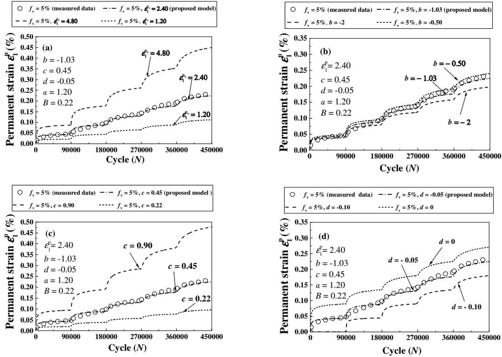
Fig. 8. Effects of parameters  $\varepsilon_1^{p0}$ ,  $b$ ,  $c$  and  $d$  in  $t(f_v, \Delta q_{max})$  on permanent strain curve: (a) parameter  $\varepsilon_1^{p0}$ ; (b) parameter  $b$ ; (c) parameter  $c$ ; (d) parameter  $d$
