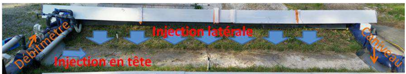
Figure 1. Dispositif d'alimentation de la noue d'infiltration.
