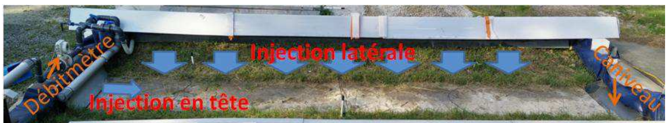
Figure 1. Dispositif d'alimentation de la noue d'infiltration.
