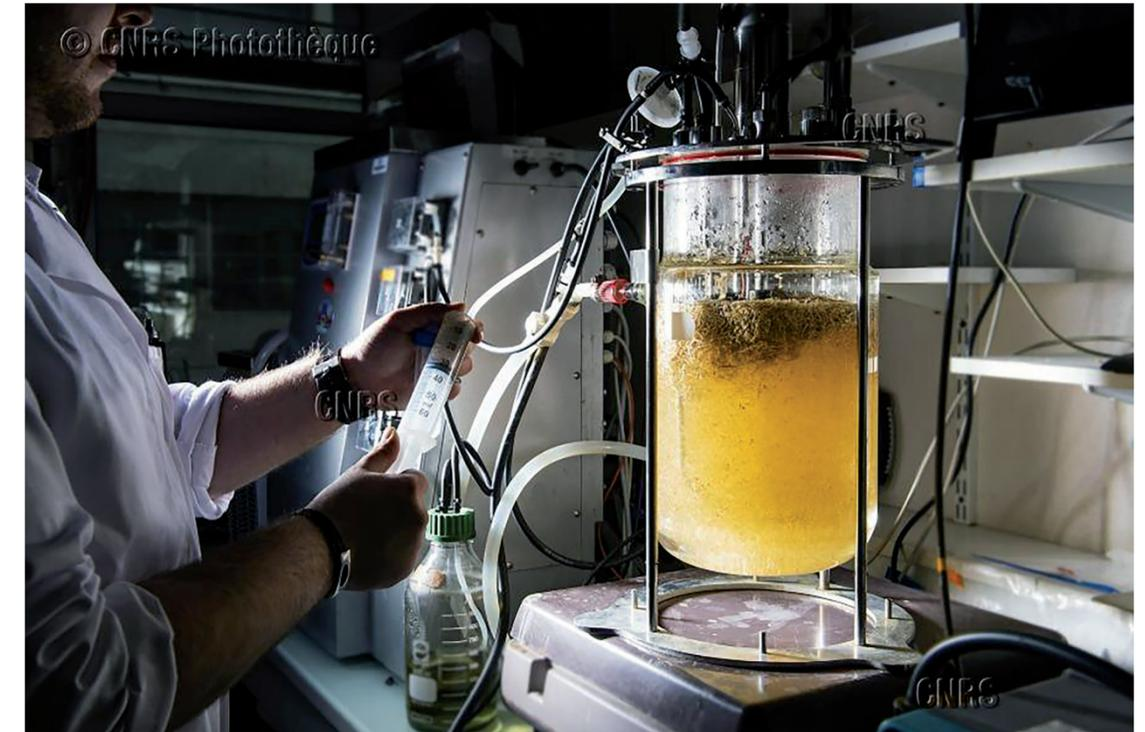
Dispositif de production d'hydrogène par fermentation. Des substrats celluloseux sont dégradés pour produire du biogaz (composé d'hydrogène et de dioxyde de carbone) et des acides gras volatiles.
