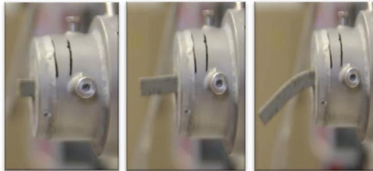
*Fig. 1. Suivi de la déformation d'une couche en porte-à-faux.*
