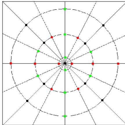
Figure 2 : Schéma de la répartition des réservations dans la dalle : profondeur de réservation : 1 cm (■) ; 4 cm (■) ; 7 cm (■) et rayons : **R0** (centre de la dalle), **R1** (petit rayon = 5 cm), **R2** (rayon moyen = 20 cm) et **R3** (grand rayon = 40 cm)
