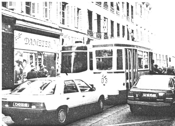
Fig. 12. De même, un tramway à écartement métrique, comme ci-dessous celui de St-Étienne, ne peut être connecté au réseau ferré national (photo J-R. Fournier).
