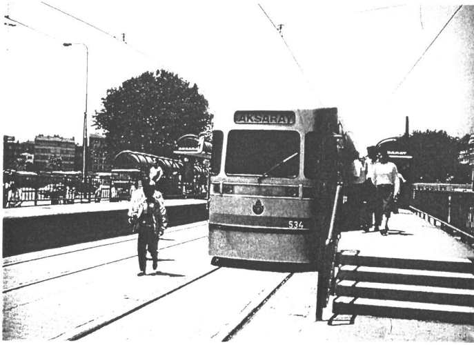
Fig. 13. «L'utilisation de ce matériel conçu pour un tout autre usage a nécessité la construction de quais hauts, peu pratiques dans une rue piétonne en centre ville (photo E. Fouache).
