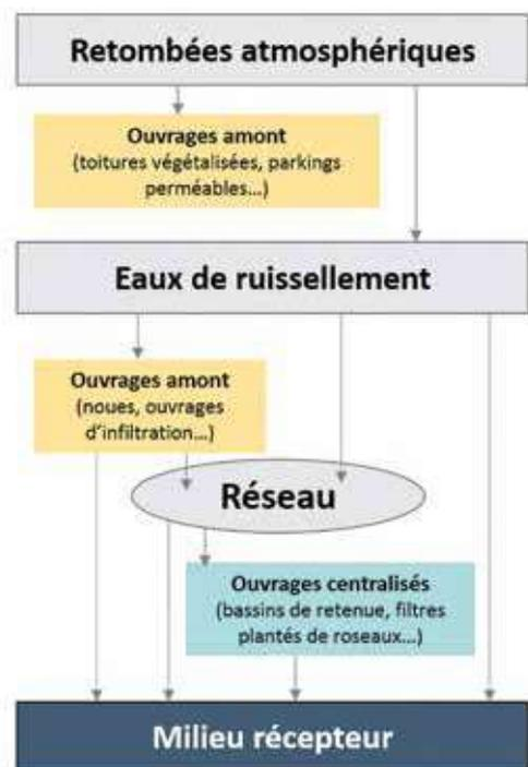
Figure 20 : Gestion centralisée et amont des eaux pluviales en réseaux séparatif ou unitaire.
