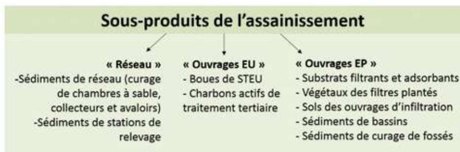
Figure 23 : Différents types de sous-produits de l'assainissement (EU : eaux usées, EP : eaux pluviales).
