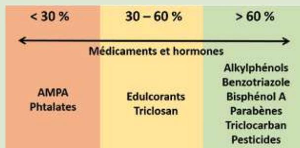
**Figure 19 : Taux d'abattement (%) des micropolluants organiques obtenus par adsorption sur charbon actif en micrograins sur le pilote Carboplus (Mailler, 2015). Édulcorants : acesulfame, saccharin et sucralose.**
