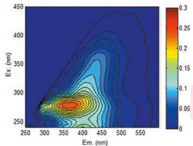
**Figure 26 :** Spectre de fluorescence 3D d'un échantillon d'eau usée, normalisé au carbone organique dissous. Longueurs d'ondes d'émission (en abscisse) et d'excitation (en ordonnées). Les couleurs représentent l'intensité de la fluorescence (exprimée ici en unité Raman L/mgC, source LEESU)
