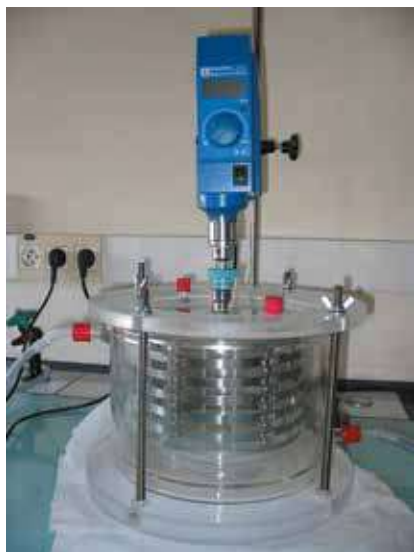
Figure 25 : Photo d'un échantillonneur passif de type membranes polymériques lors d'une calibration en laboratoire (source LEESU).
