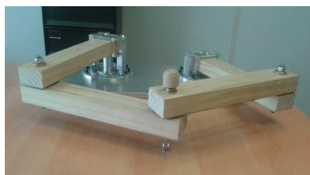
Fig. 2 : Maquette de mécanisme à cinq barres en bois (Accoya Pin)
