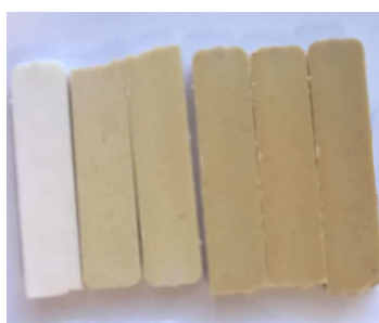
Fig. 1 : Echantillons de WPCs en fonction du taux d'incorporation de bois d'épicéa
