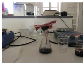
Fig. 1 : Extraction des polyphénols de la sciure d'OKoumé
