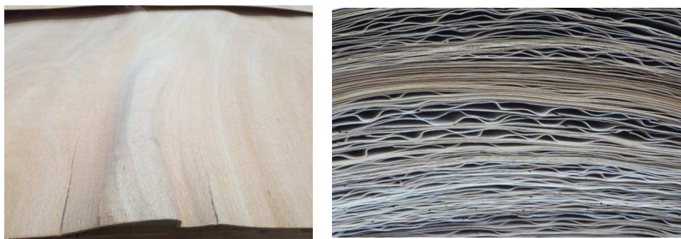
Fig. 1 : Illustration du phénomène d'ondulation des placages secs
