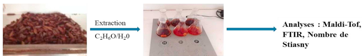
Fig.1 : Extraction des polyphénols d'acajou.
