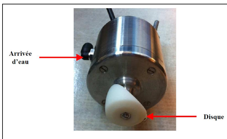
Figure 18. Simulateur de pluie à disque tournant (Van de Voorde 2012)
