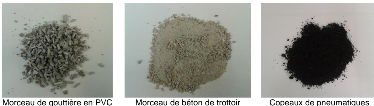
Figure 14. Echantillons découpés pour les essais de lixiviation
