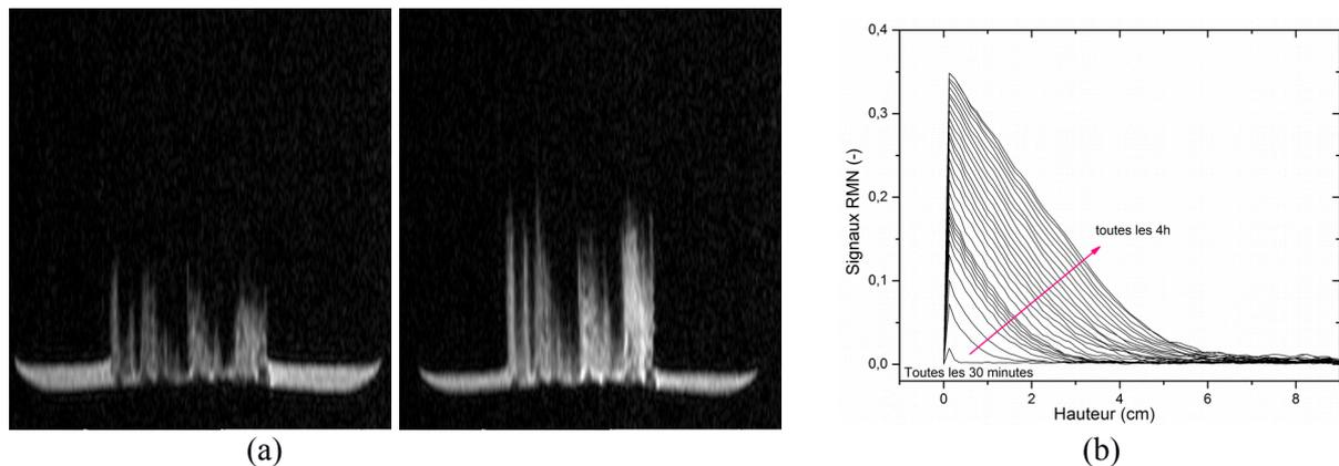
**Figure 1:** (a) Image par IRM de la distribution d'eau dans une tranche interne de l'échantillon en coupe longitudinale, à deux temps différents : 7h (à gauche) et 77h (à droite) après le début de l'imbibition ; (b) Distribution de teneur en eau au cours du temps le long de l'axe vertical du bois : au début profils toutes les 30 minutes, puis toutes les 4 h.
