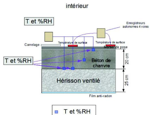
Fig. 2 : instrumentation du plancher en béton de chanvre
