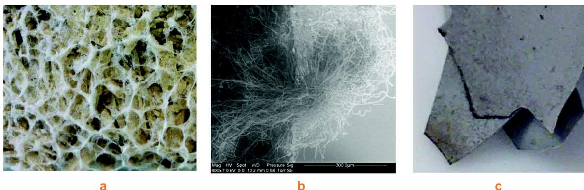
Fig. 2 : (a) développement de moisissures sur un béton de chanvre,
