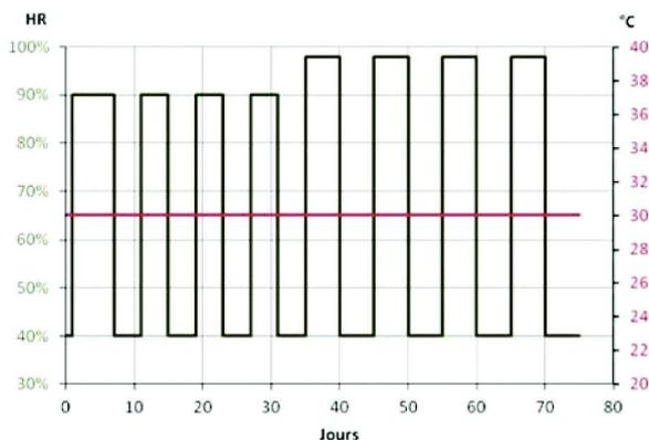
Fig. 1 : cycles de vieillissement imposés aux bétons de chanvre [Abdellaoui, 2014]
