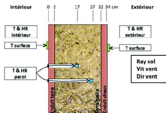
Fig. 1 : coupe schématique de la paroi instrumentée
