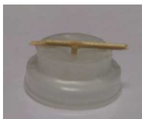
Fig. 1 : Eprouvette pour tests d'imbibition d'eau Fig. 2 : Coupe RT pendant l'imbibition
