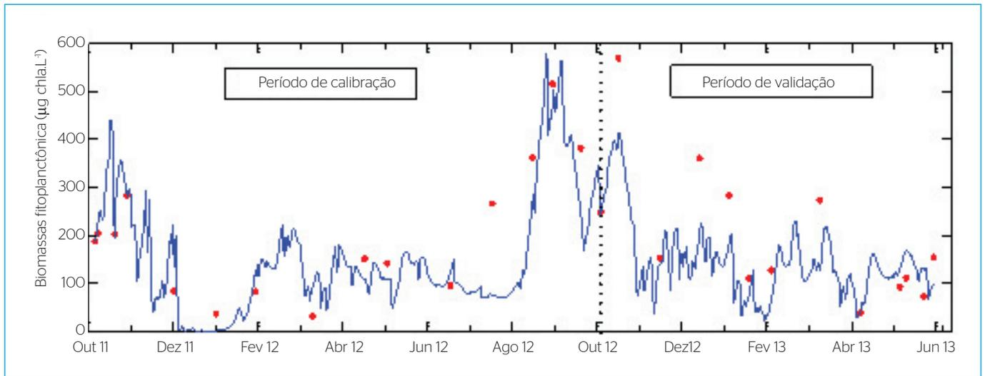
**Figura 3** - Resultados do modelo (linha) e medidas em campo (pontos) para a biomassa fitoplanctônica a 0,50 m de profundidade na Lagoa da Pampulha (Belo Horizonte, Minas Gerais). A linha vertical pontilhada separa os períodos de calibração (de 18 de outubro de 2011 a 18 de outubro de 2012) e validação (de 19 de outubro de 2012 a 04 de junho de 2013) do modelo.
