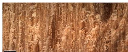
Fig. 3: Surfaces poncées du hêtre (Vf=3m/mn ; P80-120-180)
