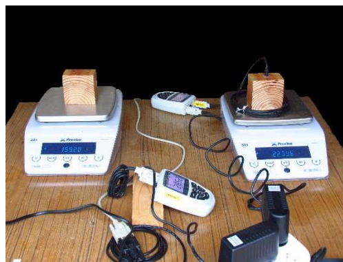
Fig. 2 : Essai de diffusion en ambiance non contrôlée
