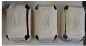
Fig. 1 : Rupture des moules en 1,2 mm lors du séchage
