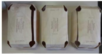
Fig. 1 : Rupture des moules en 1,2 mm lors du séchage
