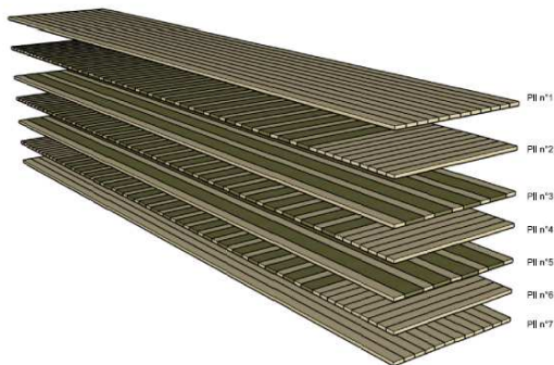
Figure 1 : structure bois à 7 plis
