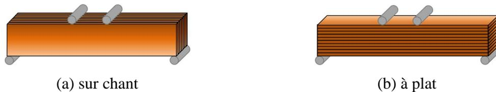
Fig. 2 : Schémas d'essais de flexion 4 points sur chant (a) et à plat (b)
