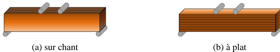
Fig. 2 : Schémas d'essais de flexion 4 points sur chant (a) et à plat (b)
