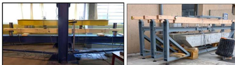
Fig. 1 : Poutres de Douglas entaillées en fluage en condition externe.
