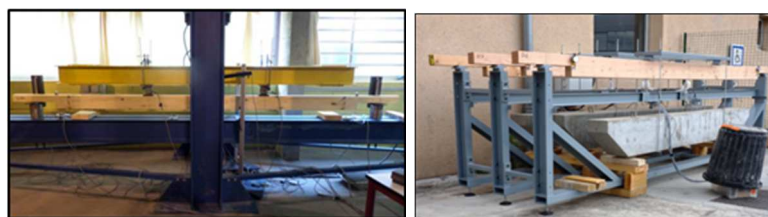
Fig. 1 : Poutres de Douglas entaillées en fluage en condition externe.
