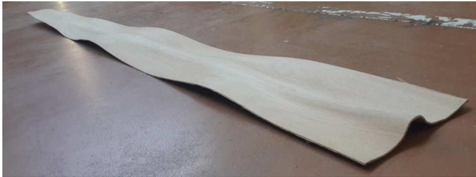
Figure 1 : Illustration du phénomène d'ondulations des placages secs
