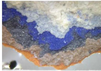
Fig. 4 : Vue de dessous de différentes couches de peinture. La peinture bleue, très visible, permet de cibler les analyses.
