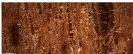
Fig. 2 : Surfaces rabotées du hêtre (Vf=30m/mn ; Vc=31,4m/s)
