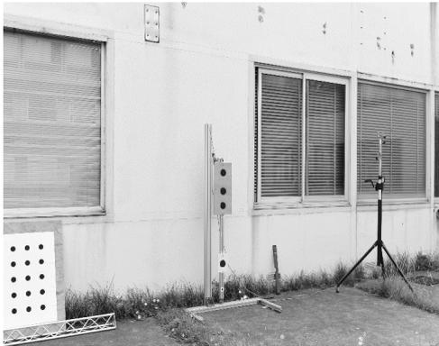
Fig. 1 : Déplacement de cible hors plan à l'aide d'un capteur à fil : Image de gauche
