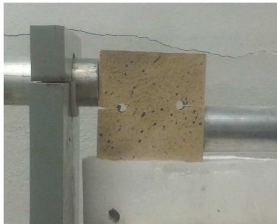
Fig. 1 : échantillon de bois maintenu entre les barres entrante et sortante, décalées, du dispositif de barres de Hopkinson
