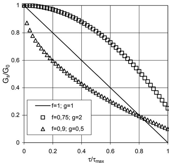
Figure 1. Evolution du module de cisaillement réduit  $G_s/G_0$  en fonction du cisaillement réduit  $\tau/\tau_{\max}$ .
