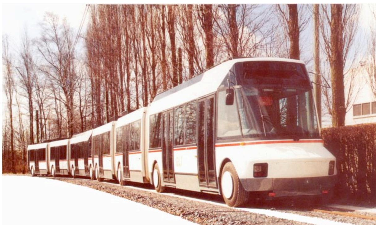
Photo de 2 GLT (ancêtre du TVR) bi articulés, accouplés en une rame multiple. La Brugeoise et Nivelles avance une capacité potentielle, à 6 voyageurs au m<sup>2</sup>, de 400 à 600 voyageurs selon que l'on accouple deux ou trois véhicules ensemble. (Source: collection J. Evrard. <http://www.trams-trollevbus.be>)
