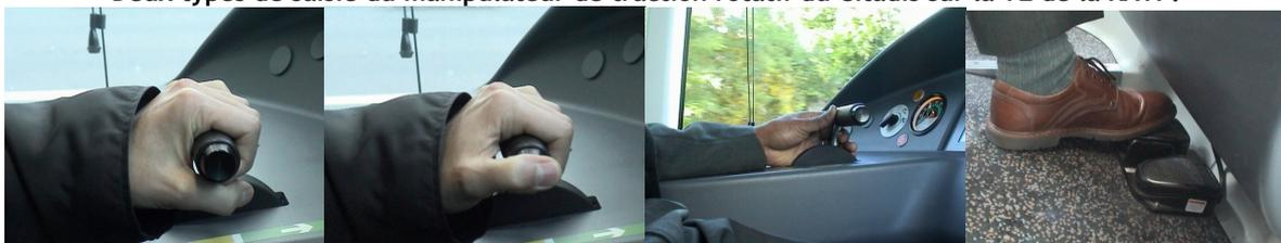
Sur les deux premières photos, le conducteur peut activer la veille avec le pouce (2<sup>ème</sup> photo) en même temps et dans le même mouvement qu'une action sur le manipulateur traction. Sur la 3<sup>ème</sup> photo, cette saisie ne permet plus d'activer simultanément la veille. Elle n'est possible que parce qu'une pédale d'activation de la veille a été ajoutée (4<sup>ème</sup> photo).
