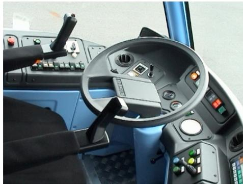
Bouton d'actionnement de la clochette sur la poignée de l'accoudoir de gauche du TVR, confondu avec un bouton d'actionnement de la veille
