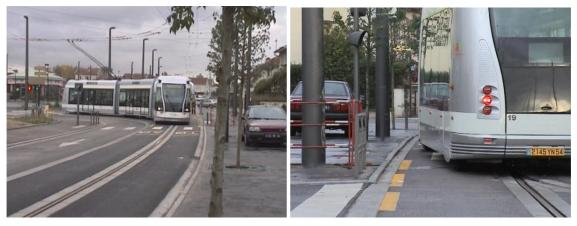
Photos de la sortie du terminus de Essey-Mouzimpré. Le tramway emprunte le site propre et longe le trottoir en sortie de virage. Sur la photo de droite, le poteau en cause dans les accidents de mars est entouré de barrières.
