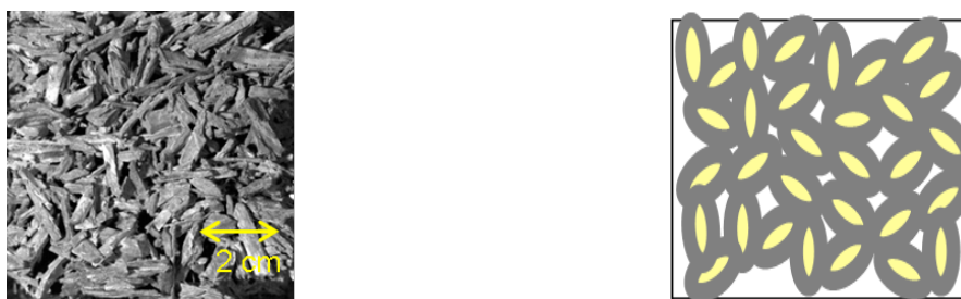
Fig. 1 : Aspect général du béton de granulat de bois par une caméra optique et schéma de modélisation
