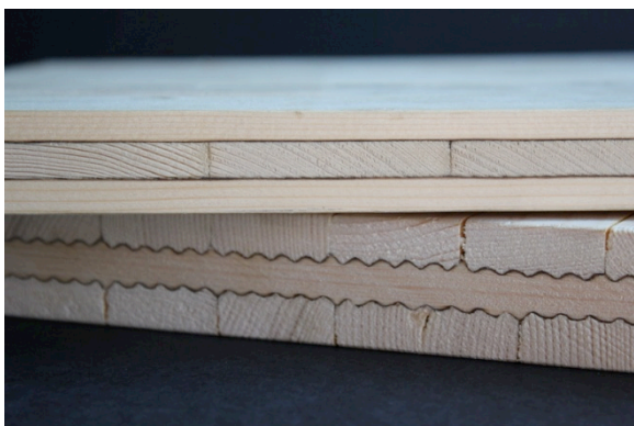
Fig. 1: Prototypes de panneaux lamellé-croisé à petite échelle
