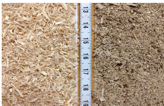
Figure 1. Fibre de peuplier broyé à 2 mm (à gauche) et Sciure de peuplier (à droit)
