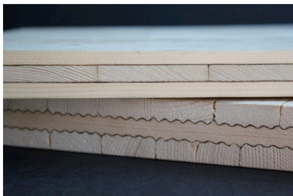
Fig. 1: Prototypes de panneaux lamellé-croisé à petite échelle
