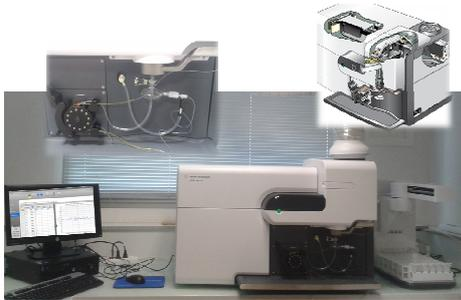
Fig. 1 : Spectromètre d'émission à Plasma micro-ondes MP-AES 4100 AGILENT, CIRAD, UR114 BiowooEB.
