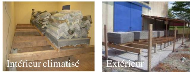
Fig. 1 : Essais de fluage en conditions de service
