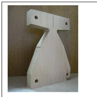
Fig. 1 : Géométries de l'éprouvette MMCG
