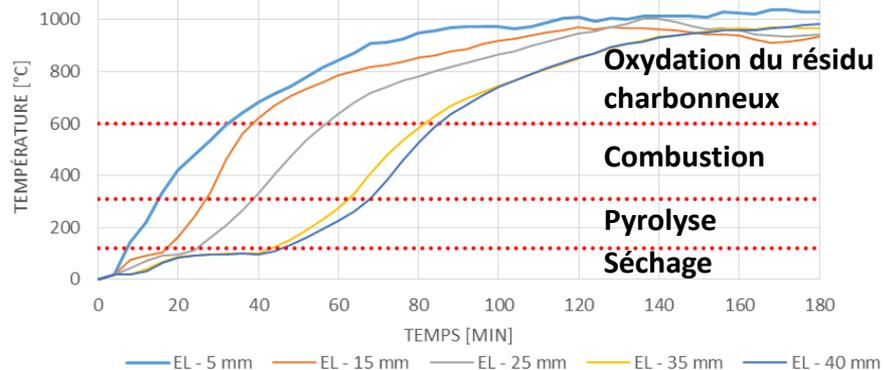
Variation de la vitesse de chauffage dans le bois d'épicéa dans la direction longitudinale
