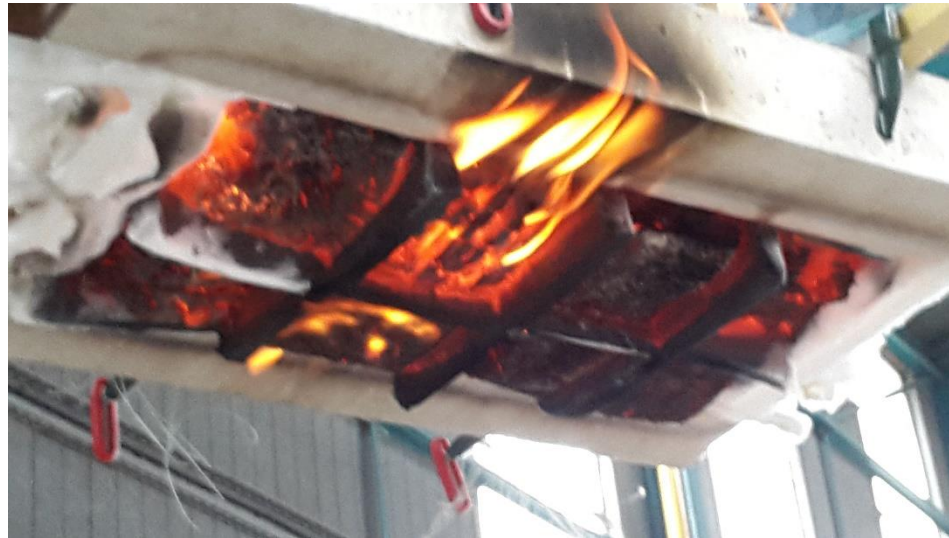
Etat des éprouvettes après 3h d'exposition à un feu ISO 834-1
