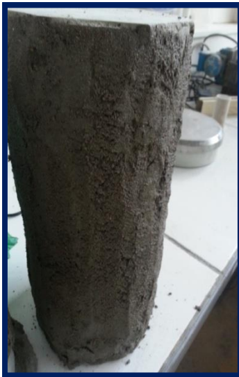
Eprouvette endommagée à 35% confinée par MML
