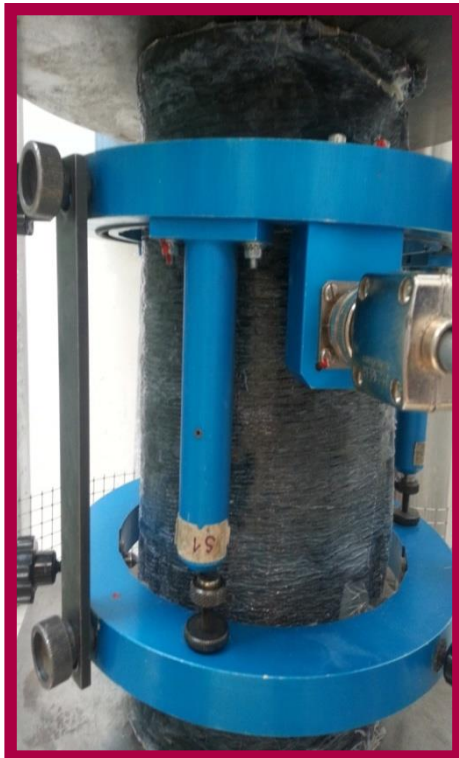
Eprouvette réparée par PRFC
