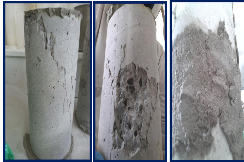
Eprouvette endommagée à 70.4% confinée par MML
