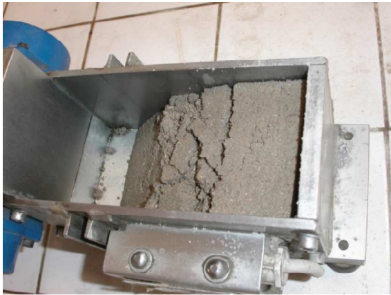
Figure 3 Ecoulement dans un maniabilimètre (E/C=0,4 ;H/C=0%)
