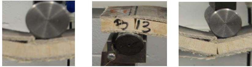
Figure 3: Quelques modes de rupture des éco-matériaux sandwichs.
