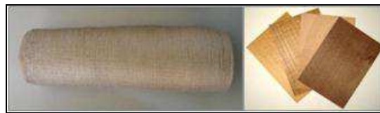
Figure 3: Renforts naturels: Fibres long unidirectionnelle continues en lin (à gauche) et placage en bois (à droite)
