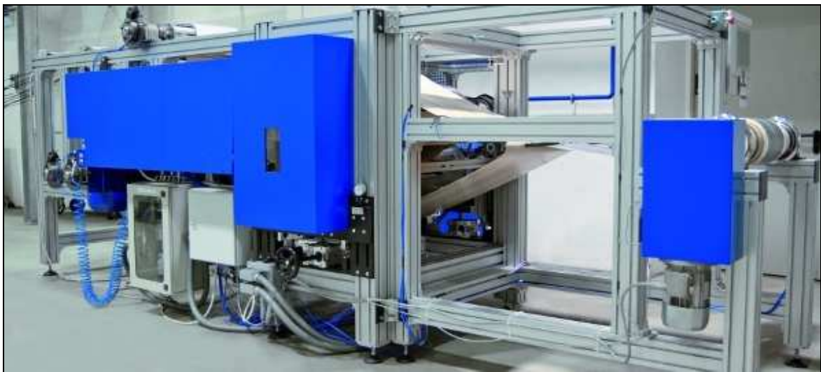
Figure 6: image de l'installation de Cetex® pour la production de prepegs
