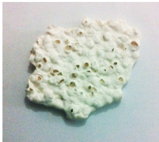
Figure 2 : Échantillon en kaolin mélangé avec de l'alumine et des billes de polystyrène.
