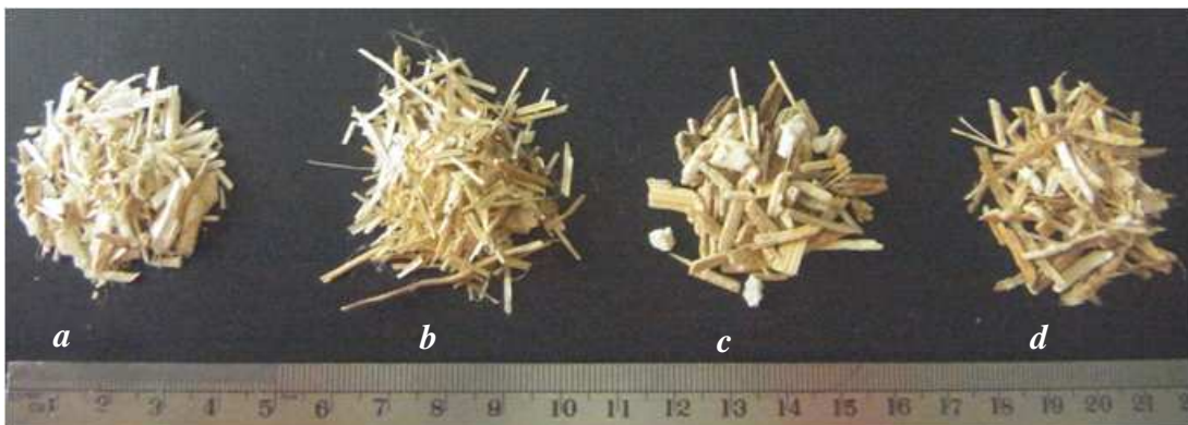
Figure 1 : Echantillons des quatre agroressources : chènevotte (a), anas de lin (b), écorce de tournesol (c) et paille de colza (d).
