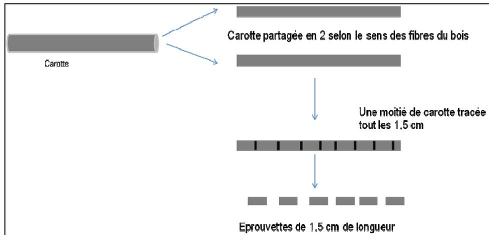
Figure 2 : Schéma expliquant les découpes des carottes
