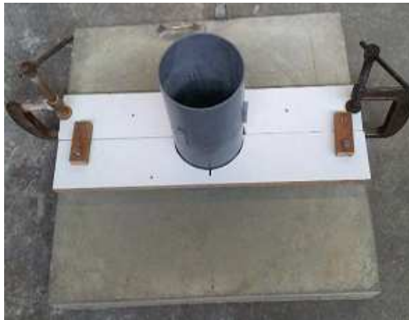
Figure 8 : Moule et hausse amovible fixé sur une table à chocs pour béton.
