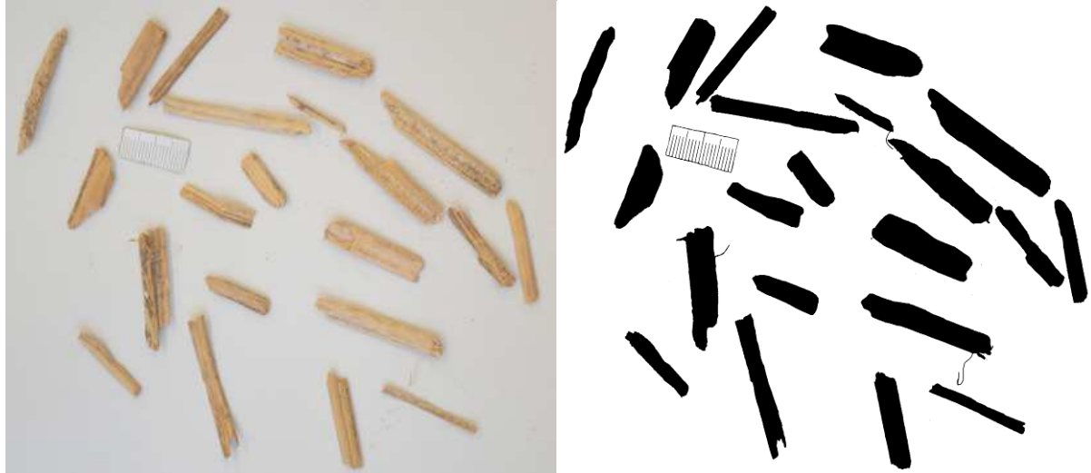
Figure 2 : Avant/après binarisation : exemple de particules de la "classe 10/12,5".
