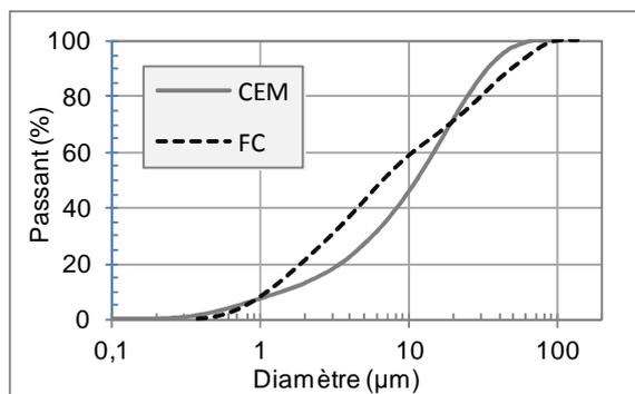
Figure 1 : Analyse granulométrique du ciment (CEM) et du fine calcaire (FC).
