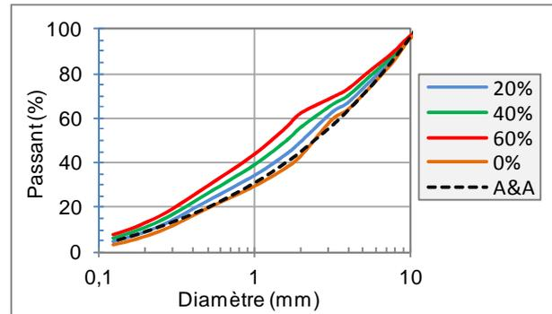
Figure 3 : Courbes granulométriques des squelettes granulaires des bétons.
