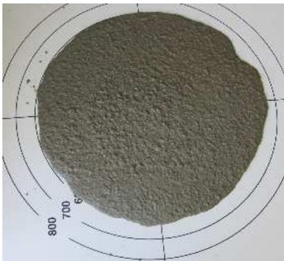
Figure 4 : Test d'étalement au cône d'Abrams.
