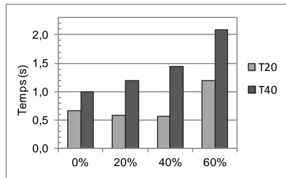
Figure 10 : Temps d'écoulement T<sub>20</sub> et T<sub>40</sub> à la boîte L.
