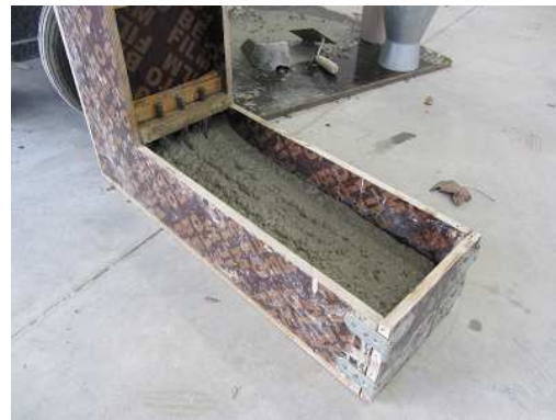
Figure 5 : Test du blocage à la boîte L
