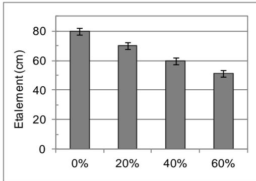
Figure 7 : Étalement au cône d'Abrams.
