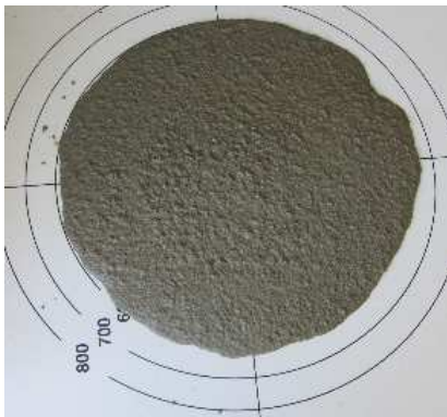
Figure 4 : Test d'étalement au cône d'Abrams.
