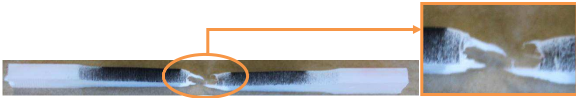
Figure 3 : Etirement d'une éprouvette de 10BS.
