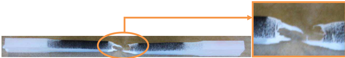
Figure 3 : Etirement d'une éprouvette de 10BS.
