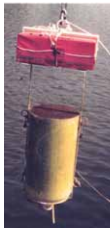
Trappe à matières en suspension maintenue hors d'eau avant d'être placée en Seine pour des durées de collecte comprises entre 24 h et une dizaine de jours.
