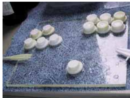
Figure 9 : Dispositifs DGT permettant d'échantillonner les métaux dissous labiles : préparation au laboratoire et immersion dans le milieu aquatique, ici une station d'épuration des eaux usées.
