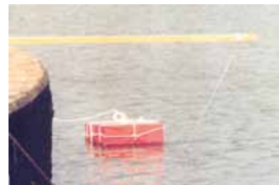
Trappe à matières en suspension maintenue hors d'eau avant d'être placée en Seine pour des durées de collecte comprises entre 24 h et une dizaine de jours.
